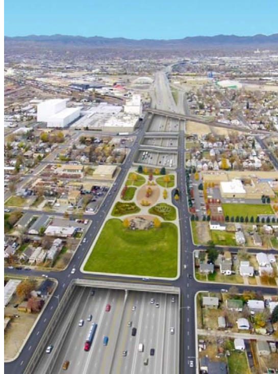
Simulación de una vista aérea de la Alternativa de Paso a Desnivel Parcialmente Cubierto, mirando al este de la Fillmore Street (Opción Básica)
